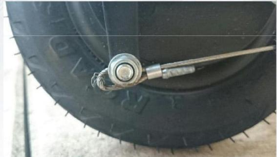
Нажатие рукоятки тормоза должно тормозить заднее колесо. При этом сама рукоятка не должна переводиться в крайнее положение, максимально близко к рукоятке рулевой колонки. В противном случае, необходимо отрегулировать механический тормоз путем натяжки регулировочного винта (смотри рис.1). Рекомендуемый зазор от 1 до 3 мм.
