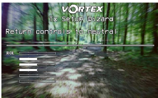
После того, как четыре основных канала управления полетом будут определены, установите модель на ровную горизонтальную поверхность и переместите правую ручку передатчика на себя, это позволит откалибровать акселерометр.
