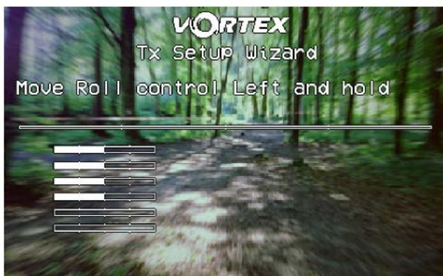
Следуйте инструкциям на экране, каждый раз убеждаясь, что вы перемещаете именно ту ручку и в правильном направлении. Как только какой-либо элемент управления будет распознан, его имя станет отображаться слева от шкалы серво монитора.
