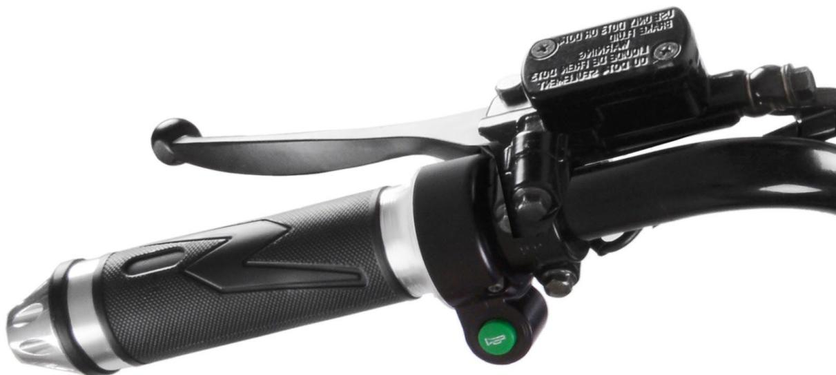
Справа на руле расположены рычаг переднего тормоза и переключатель режимов работы двигателя (SUV).
