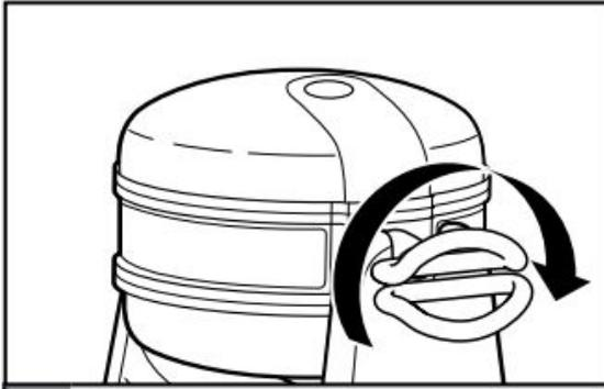
2. Поверните выпекающий блок таким образом, чтобы крышка с термометром располагалась сверху.
