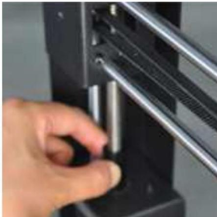
11. Вставьте раму в корпус так, чтобы отверстия для болтов совпали.
