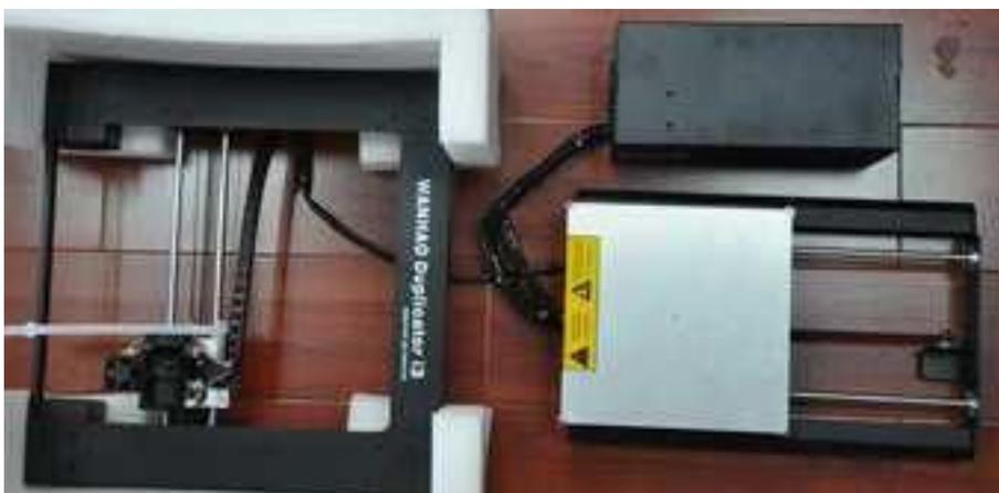
7. Поместите корпус на стол и снимите защитную наклейку на переключателе и крыльчатых гайках.
