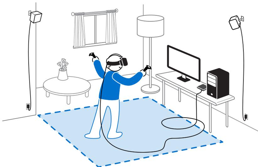
При нахождении в игровой зоне, гарнитура и контроллеры должны находиться на расстоянии от 0,5 до 5 м от базовой станции. Это обеспечит правильное отслеживание устройств в поле обзора (120 градусов) базовой станции.
