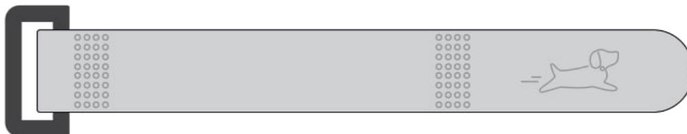
Снимите устройство с оригинального ошейника и переверните его. Возьмите универсальное крепление, так чтобы логотип находился на верхней стороне крепления, и проденьте его свободный край через ушки устройства до упора.
