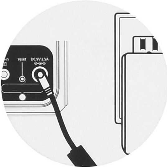
Подключите док-станцию к источнику переменного тока с напряжением от 100 до 240 В. При необходимости используйте переходник для адаптера питания типа С.
