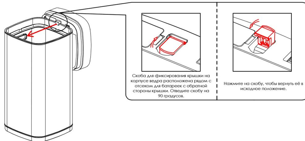
Скоба для фиксирования крышки на корпусе ведра расположена рядом с отсеком для батареек с обратной стороны крышки. Отведите скобу на 90 градусов.
