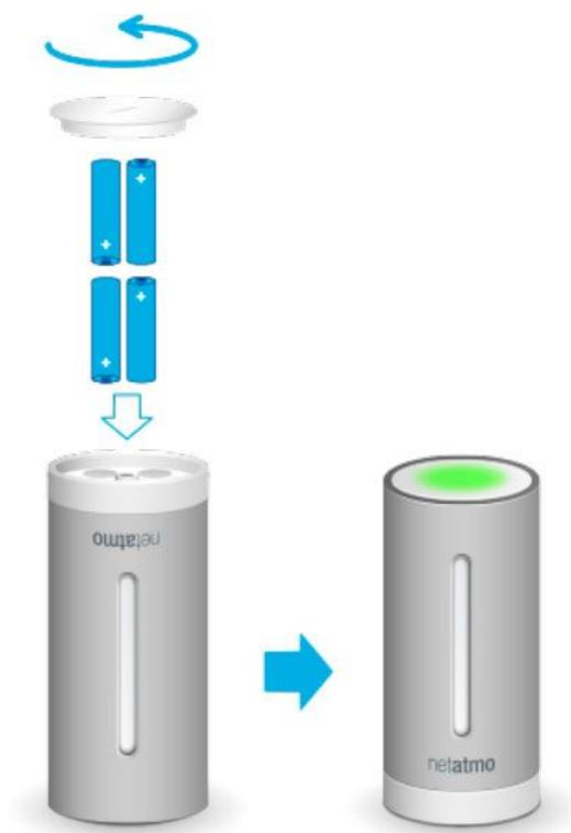
Для питания основного блока используются четыре батарейки, для питания выносного датчика – две батарейки. Установите батарейки, следуя приведенной схеме.
