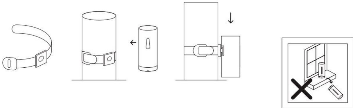
Для установки датчика рекомендуется использовать крепежную стропу и дюбель, входящие в комплект поставки. Следуйте предложенной схеме.
