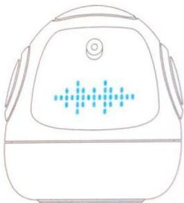
Появление волны на экране означает, что робот готов к работе в режиме диалога.
