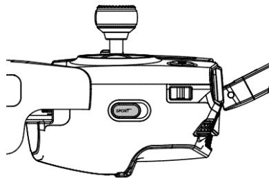
P-режим (режим позиционирования): лучше всего работает при сильном сигнале GPS. Модель использует GPS и оптическую систему для удержания положения, полета между препятствиями и слежения за движущимся объектом. Расширенные функции, такие как TapFly и ActiveTrack, могут быть включены в данном режиме.
