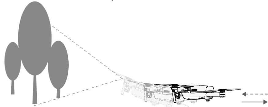
**⚠ Работа системы зависит от поверхности, над которой летает модель. Ультразвуковые датчики могут некорректно рассчитывать расстояние при полете над звукоглощающими материалами. Камера может работать некорректно в неблагоприятных условиях. Модель автоматически перейдет из Р-режима в режим стабилизации, если GPS и передняя и нижняя оптические системы недоступны. С особой осторожностью летайте в следующих условиях:**
