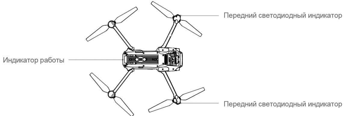
Передние индикаторы указывают на носовую часть модели. Они горят красным, когда квадрокоптер включен, указывая на расположение передней части (носа) (передние светодиоды могут быть отключены в приложении DJI GO). Индикатор работы отображает системный статус полетного контроллера. Для получения более подробной информации см. таблицу ниже.
