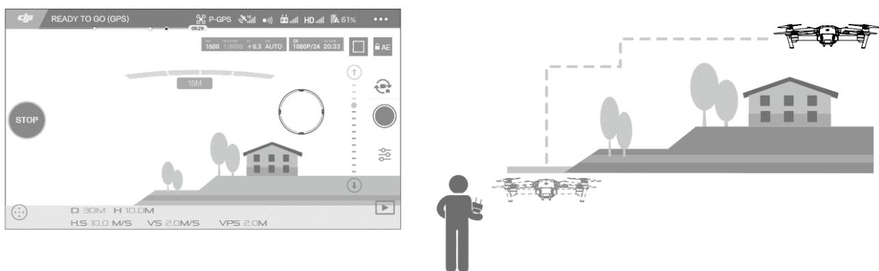
Обратите внимание, что модель автоматически отрегулирует скорость при обнаружении препятствия. Однако не следует полностью полагаться на данную функцию для навигации модели между препятствиями. Безопасный возврат отменит функцию TapFly.
