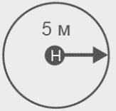
Модель автоматически спустится и приземлится при включении безопасного возврата, когда модель находится в радиусе 5 м от точки взлета.
