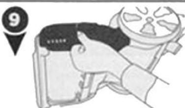
Установите на место пластинку доступа к ремням/щеточным валикам, так чтобы она закрывала торцы валиков, и закрепите ее тремя винтами.
