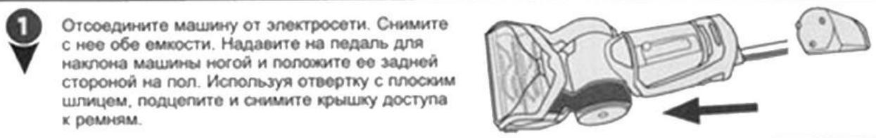
1 Отсоедините машину от электросети. Снимите с нее обе емкости. Надавите на педаль для наклона машины ногой и положите ее задней стороной на пол. Используя отвертку с плоским шлицем, подцепите и снимите крышку доступа к ремням.
