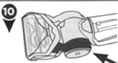
Переверните машину на заднюю сторону, а затем установите на место крышку доступа к ремням. При ее правильной установке должен быть слышен щелчок.
