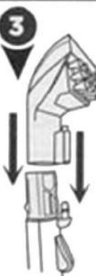
Подсоедините насадку к концу шланга (разные модели могут комплектоваться разными насадками). Подсоедините машину к надлежащим образом заземленной электророзетке и включите ее, нажав кнопку подачи питания.
