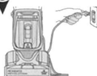
Подсоедините машину к надлежащим образом заземленной электророзетке и включите кнопку подачи питания. Проведите чистку с нажатым курком распыления в течение одного моющего движения вперед и одного моющего движения назад, а затем с отпущенными курком в течение одного высушивающего движения вперед и одного высушивающего движения назад.
