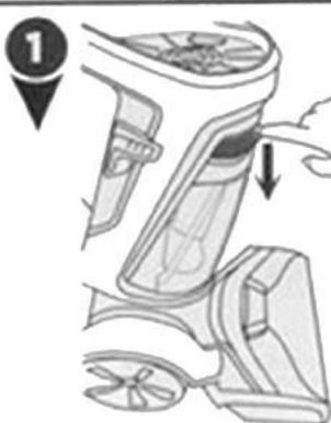
Чтобы снять емкость для грязной воды, надавите на ее цветную ручку.
