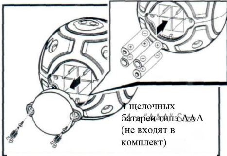
Схема размещения/установки батарей для смарт-мяча CHiP SmartBall™
