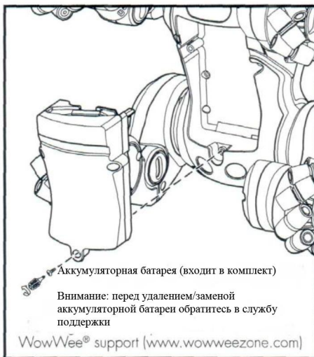
Схема размещения батарей для робота CHiP™
