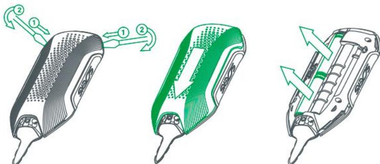
Для замены элементов питания необходимо в верхней части корпуса с правой и левой стороны поддеть тонкой отверткой крышку. Далее необходимо снять крышку, сдвинув ее вниз. Замену элементов питания необходимо производить, соблюдая их полярность, значки «+» и «-» указаны на печатной плате прибора. После замены элементов питания необходимо надеть крышку снизу-вверх и защелкнуть ее в верхней части.
