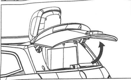
Заднее окно открывается, его можно использовать в качестве багажника. Потяните заднее стекло и поверните ручку. Заднее стекло закрывается с помощью магнита между ним и корпусом автомобиля.
