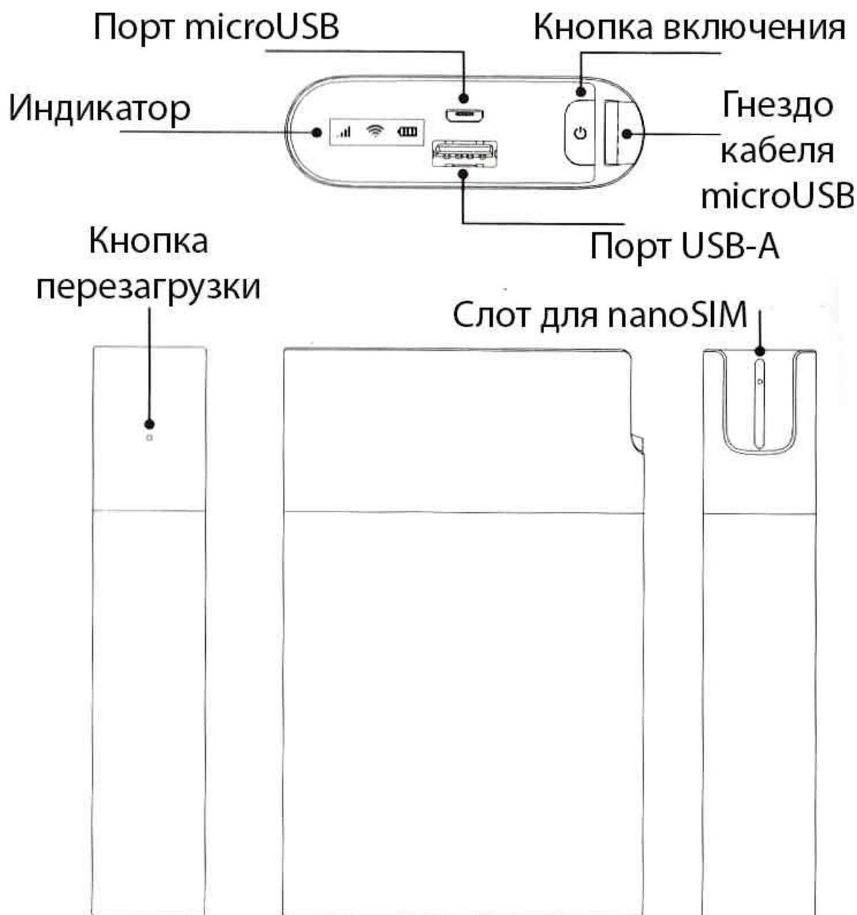
О состоянии системы можно судить по светодиодным индикаторам. Слева направо: соединение с сетью 4G, Wi-Fi-соединение и состояние батареи. Если индикатор горит зеленым часть системы работает в штатном режиме, если желтым — нет. При включение устройства все индикаторы должны загореться зеленым, при включении желтым. Для включения и выключения устройства
