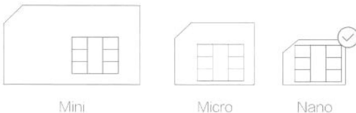
Установите подходящую карту в слот для nanoSIM, который находится в гнезде для кабеля microUSB. Для этого используйте соответствующий инструмент, как показано на нижеследующем рисунке.
