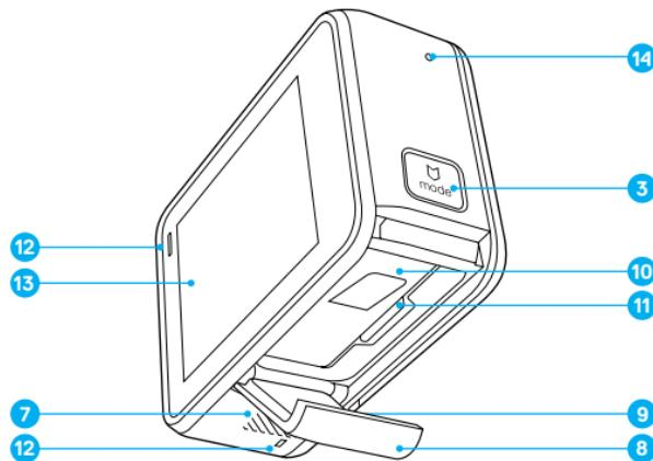
9. Кнопка фиксатора
