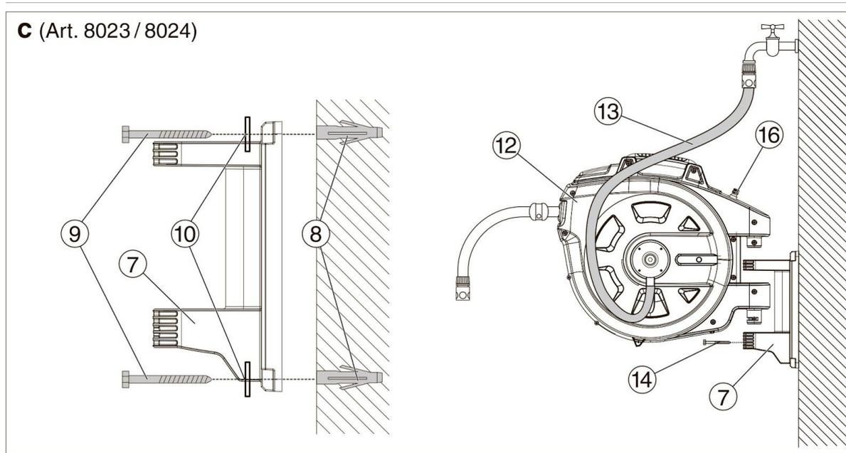
Прилагаемые дюбели подходят для бетонных стен (толщина штукатурки — до 1 см). Для других стен нужно использовать специальные дюбели.
