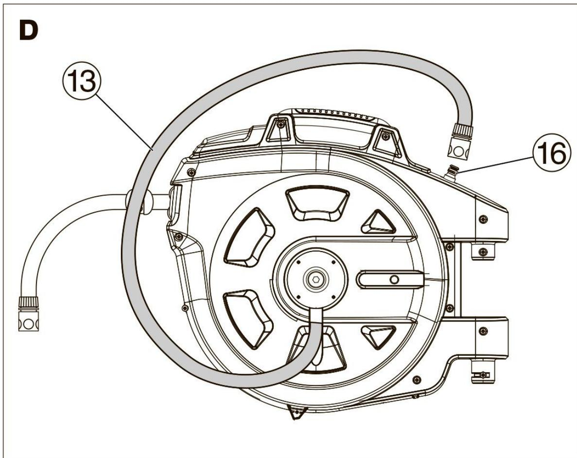
Благодаря специальному тормозу шланг надежно и равномерно сматывается самостоятельно. При разматывании и сматывании шланга слышны щелчки фиксирующего устройства. Если шланг подключения (13) будет откручен от водопроводного крана, то его конец следует вставить в бачок (16), чтобы из шланга не капала вода.
