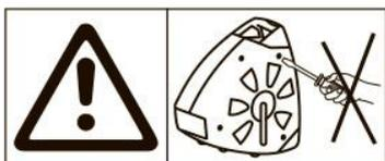
**ОПАСНО ! Возможно травмирование предварительно сжатой пружиной. Ящик для шланга нельзя открывать.**
