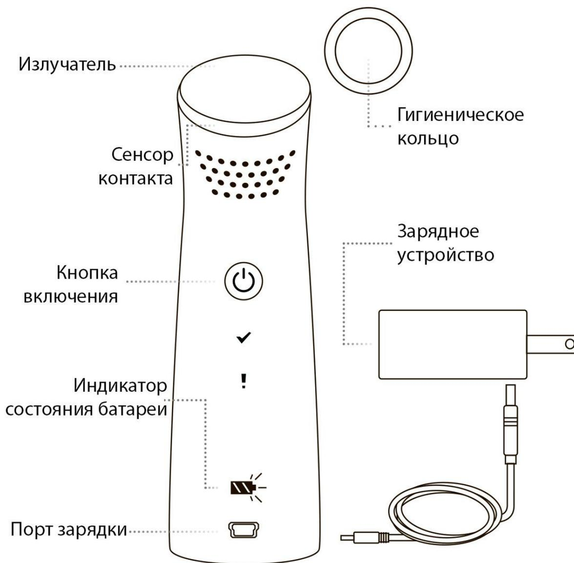
Рисунок 1. Элементы конструкции
