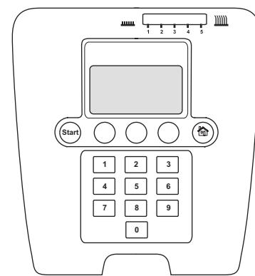
После нажатия кнопки остановки и открытия крышки в рабочем окне появится время, выбранный режим работы, число часов работы, состояние аккумуляторной батареи и настройка таймера.
