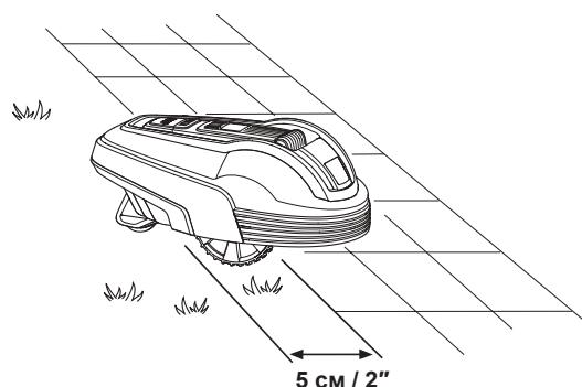
Если рабочую зону пересекает мощеная дорожка, которая находится на одном уровне с газоном, можно позволить газонокосилке-роботу немного заезжать на такую дорожку. В этом случае ограничительный провод лучше проложить под дорожкой. Также ограничительный провод можно уложить в стыках между брускаткой. Убедитесь, что плитки находятся на одном уровне с газоном во избежание чрезмерного износа газонокосилки-робота.
