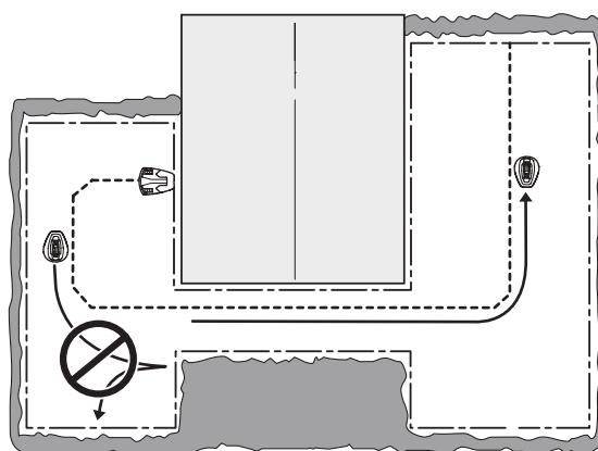
Проверка не пройдена, если газонокосилка-робот не может пройти вдоль направляющего провода весь путь до точки соединения с ограничительным проводом. Вероятно, установка была выполнена без соблюдения инструкций в разделе 3. "Установка".
