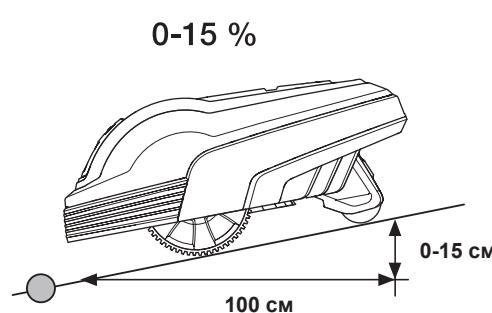
Ограничительный провод не следует прокладывать на склонах с крутизной более 15%. Существует риск того, что газонокосилке-роботу будет трудно развернуться на таком уклоне. В этом случае газонокосилка-робот остановится, и на дисплее появится сообщение об ошибке "Вне рабочей зоны". Наибольший риск возникает в сырую погоду, когда колеса могут скользить по влажной траве.
