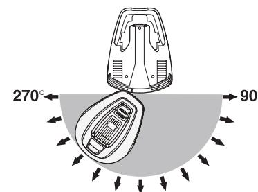
Для равномерной стрижки даже в недоступных частях сада газонокосилка-робот может следовать от зарядной станции до точки соединения направляющего провода с ограничительным проводом и начать стрижку с этого места.
