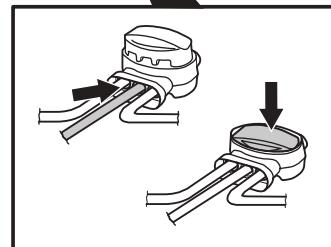
В этом случае переместите соединение нового провода ближе к отсоединеному концу (примерно посередине того участка, где, на ваш взгляд, произошел разрыв) и проверьте снова, горит ли индикаторная лампа зеленым светом или мигает желтым.
