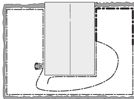
5. Обнаружив повреждение, замените поврежденную часть новым проводом. Поврежденный участок можно вырезать, если допустимо укорачивание ограничительного провода. Всегда используйте оригинальные соединители.
