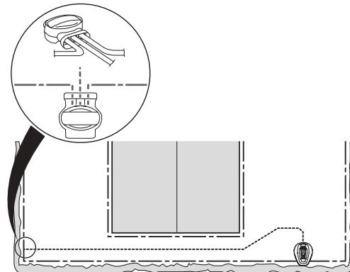
Используйте клеммы, чтобы полностью вдавить кнопку на соединителе.
