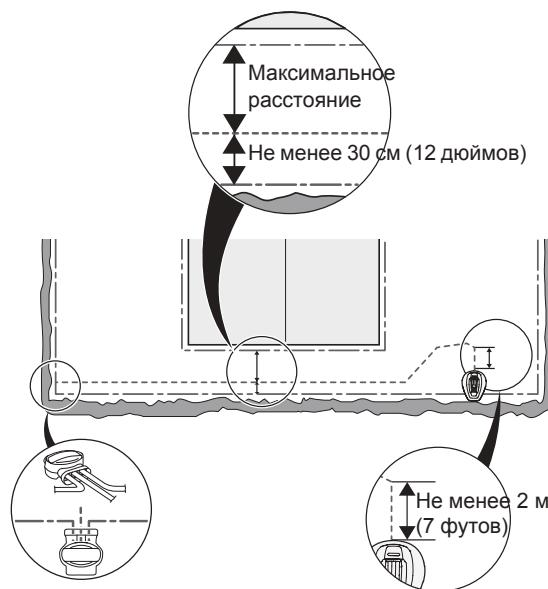
Если направляющий провод должен быть проложен на крутом склоне, желательно проложить его под углом к склону. Это упрощает следование газонокосилкой-роботом за направляющим проводом на склоне.
