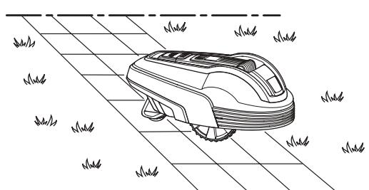
Примечание. Следует принять меры по предотвращению движения газонокосилки по гравию, мульчу или подобному материалу, который может повредить ножи.
