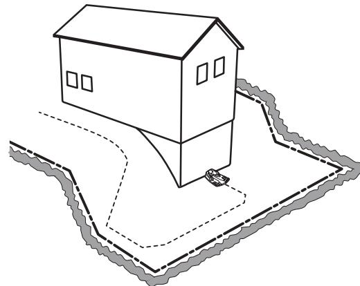
Не создавайте при прокладывании провода острых углов. Это затруднит газонокосилке-роботу следование за направляющим проводом.
