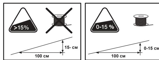
Если часть внешней границы рабочей зоны имеет уклон более 15 см на метр (15%), ограничительный провод следует прокладывать примерно в 20 см от границы ровного участка земли перед началом склона.
