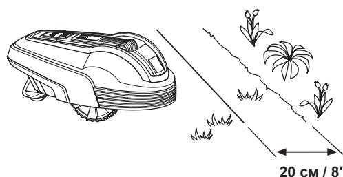
Если рабочая зона граничит с мощеной дорожкой или другим препятствием, которое находится на одном уровне с газоном, можно позволить газонокосилке-роботу немного заезжать на такую дорожку. В таком случае ограничительный провод необходимо проложить на расстоянии 5 см от края дорожки.
