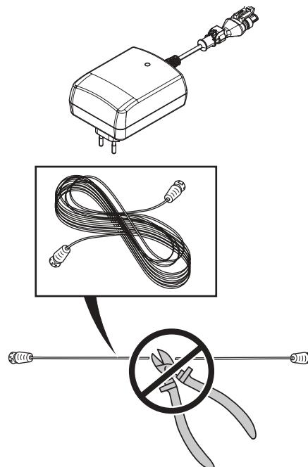
Кабель низкого напряжения для источника питания имеет длину 10 м; его запрещено укорачивать или удлинять.
