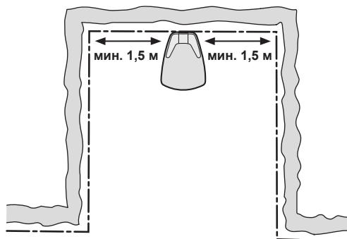
Запрещается размещать зарядную станцию в углу рабочей зоны. Справа и слева от зарядной станции должен быть проложен прямой отрезок ограничительного провода длиной не менее 1,5 м.
