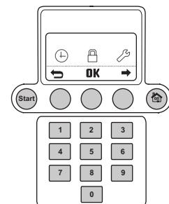
Кнопочная панель состоит из четырех групп кнопок: кнопка выбора режима работы, кнопки выбора, цифры и кнопка запуска.
