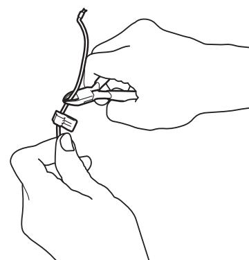
4. Прижмите разъем к металлическому контакту. Прижмите разъем к контакту с обозначением AL (левый) и AR (правый) на зарядной станции.
