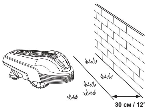
Если рабочая зона граничит с небольшой траншеей, например, цветочной клумбой или небольшим возвышением или низким бордюром (высотой 3-5 см), ограничительный провод должен проходить в 20 см от границы рабочей зоны. Это предотвратит попадание колес в траншеею или наезд на бордюр.
