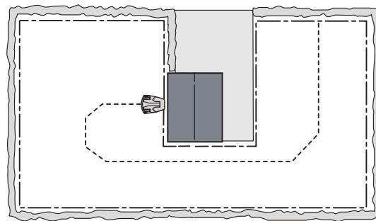
Не размещайте зарядную станцию в труднодоступных местах рабочей зоны. Справа и слева от зарядной станции должен быть проложен прямой отрезок ограничительного провода длиной не менее 1,5 м. Провод должен быть проложен напрямую от задней части зарядной станции. Любое другое расположение зарядной станции может привести к тому, что газонокосилка-робот будет стыковаться с зарядной станцией под углом, и ее подключение к зарядной станции может быть затруднено.
