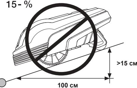
Тем не менее, ограничительный провод можно прокладывать на склонах с крутизной более 15% при наличии препятствия, с которым газонокосилке-роботу можно сталкиваться (например, забор или густая живая изгородь).
