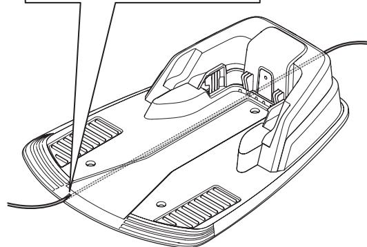
2. Установите разъем на направляющий провод таким же способом, как и на ограничительный провод, в соответствии с инструкциями в разделе 3.5 "Подсоединение ограничительного провода" на стр. 29. Подсоедините его к контакту на зарядной станции с маркировкой "Guide" (Направляющая).
