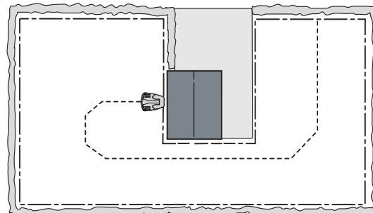
После полной зарядки аккумуляторной батареи газонокосилка-робот покидает зарядную станцию в случайно выбранном направлении в пределах выходного сектора 90°-270°.
