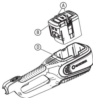
1. Нажмите на обе кнопки разблокировки (A) и выньте аккумулятор (B) из ответной части аккумулятора (D).
