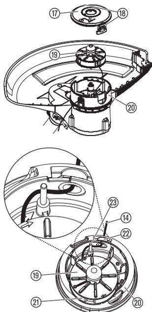
1. Одновременно нажмите на две защелки (18) крышки катушки (17) и снимите ее.
