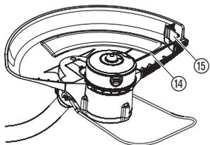
**Контролируемая полуавтоматическая подача корда действует при работающем моторе.** Ровная стрижка травы возможна только при максимальной длине выпущенного корда. В случае необходимости перед первым включением следует несколько раз увеличить длину триммерного корда.
