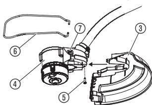
1. Надвиньте защитный кожух ③ на головку триммера ④.
