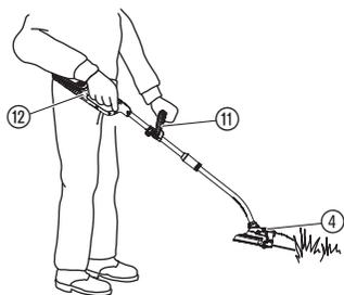
→ Держите изделие за дополнительную рукоятку (11) и главную рукоятку (12) так, чтобы головка триммера (4) была слегка наклонена вперед.
