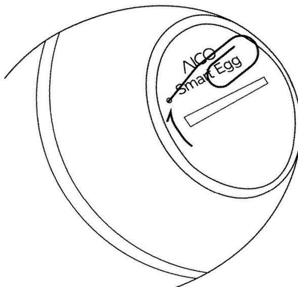
Для перезагрузки зажмите кнопку с подписью Reset в течение пяти секунд. Для этого можно использовать любой подходящий предмет — например, канцелярскую скрепку.
