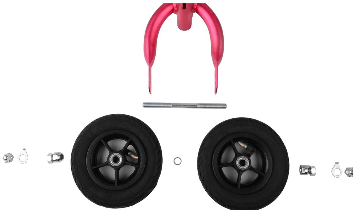
Установите собранную конструкцию между перьями рамы и зафиксируйте с двух сторон с помощью стопорных шайб и крепежных гаек.
