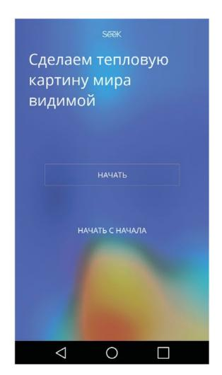
Нажмите «Начать», и вы попадете на домашний экран приложения. Для дальнейшей работы установите тепловизор в разъем Lightning своего смартфона. При первом подключении тепловизора приложение автоматически предложит пройти регистрацию, которую можно пропустить.
