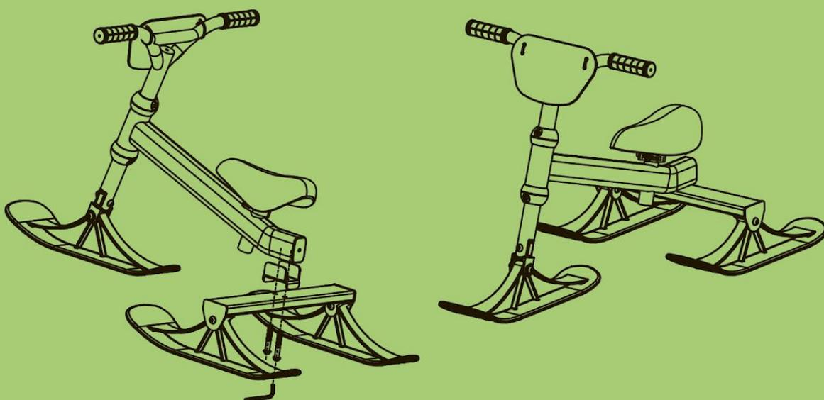
**6. Отрегулируйте необходимую высоту сиденья, отжав язычок зажима-эксцентрика, а затем туго затянув его. Не поднимайте сиденье выше указанной на трубке отметки.**
