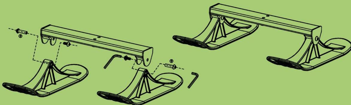
**5. Соедините обе части рамы с помощью фиксатора и винтов.**
