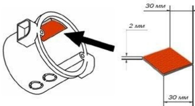
Таким образом, система крепится над предполагаемым источником пожара, обеспечивая максимальную защиту от возгорания. При превышении температурой заданного порога (100-120 °С) срабатывание системы происходит мгновенно, при этом прямому воздействию подвержен только очаг возгорания, в то время как окружающие предметы остаются нетронутыми ни активным веществом, ни пожаром. После устранения источника пожара необходимо обязательно заменить отработанный пиростикер на новый.
