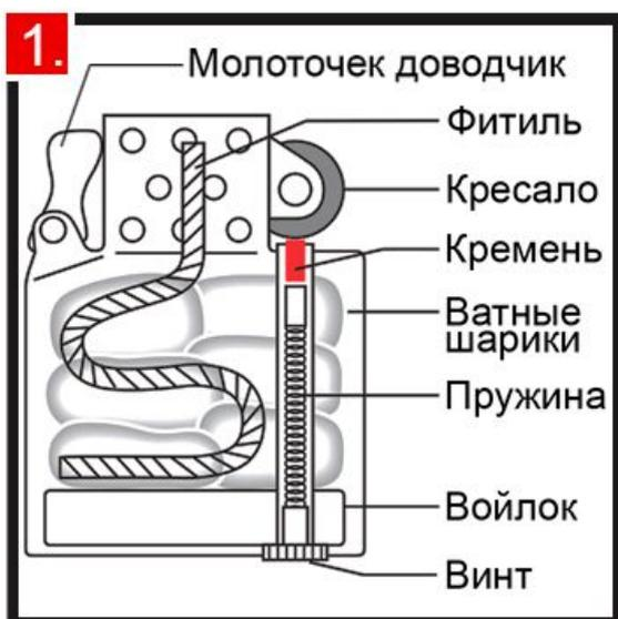
Схема внутреннего устройства зажигалки.
