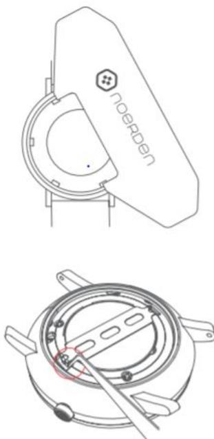
С помощью тонкого инструмента удалите удерживающую скобу. Осторожно извлеките батарейку и замените ее новым элементом питания стандарта CR2032. Батарейка устанавливается минусом вниз. Установите удерживающую скобу на прежнее место.
