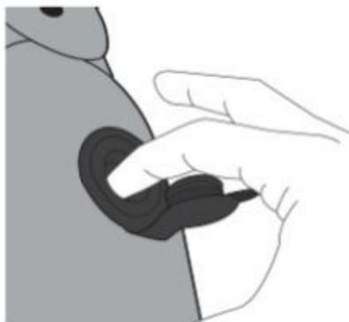
Закройте крышку клапана, чтобы избежать утечек воздуха.
