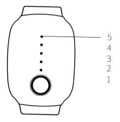
Для того чтобы проверить уровень зарядки один раз нажмите на кнопку управления в выключенном состоянии. Если горят все пять светодиодов — устройство заряжено полностью.
