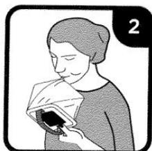
Надуйте устройство через воздушный клапан, находящийся в донной части устройства.
