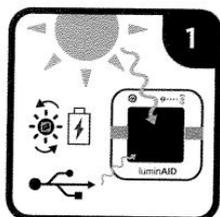
Зарядите устройство под прямыми солнечными лучами в течение 14 часов. При помощи кабеля micro-USB зарядка может производиться за 1-2 часа.
