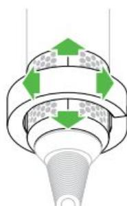
Сдвиньте щетку для очистки фильтра на кабель и на решетку фильтра.
