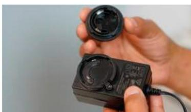
2 Расположите адаптер в соответствии с контактами на зарядном устройстве и поверните его, чтобы зафиксировать на месте.
