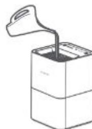
2. Снимите верхнюю часть очистителя и долейте воду непосредственно в резервуар. Старайтесь не превышать максимальный уровень воды.
