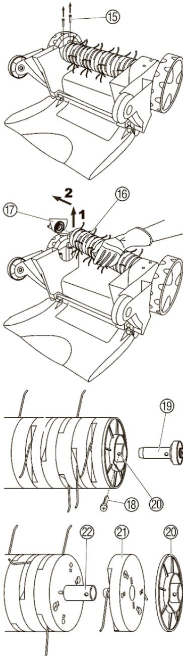
1. Вывернуть два болта **15** на нижней стороне корпуса.
