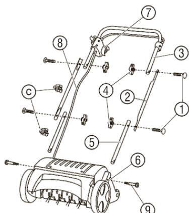
1. Вставьте обе поперечины ⑤ (концом с круглым отверстием) в корпус мотора ⑥ и закрепите их болтами с крестовидными головками ⑨.
