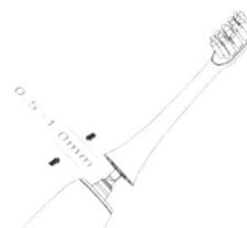
Установите насадку на ручку зубной щетки. Необходимо оставить небольшой промежуток между двумя частями зубной щетки для того, чтобы головка зубной щетки не сталкивалась с ручкой зубной щетки во время высокочастотной вибрации и двигатель работал на полную
