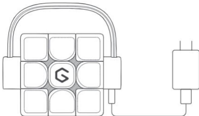
Процесс полной зарядки занимает около 1,5 часа. Когда батарея будет полностью заряжена, устройство начнет подавать звуковые сигналы.
