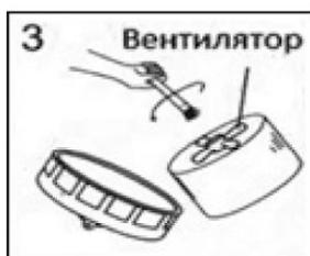
Почистите среднюю часть и вентилятор при помощи специальной щетки. Также можно протирать их влажной салфеткой.
