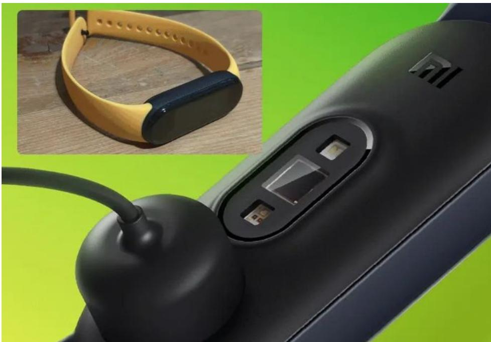
Подключите другой конец кабеля к любому разъему USB с силой тока не менее 0,5 А (это может быть порт, расположенный на корпусе компьютера, адаптера питания или аккумулятора-пауэрбанка).
