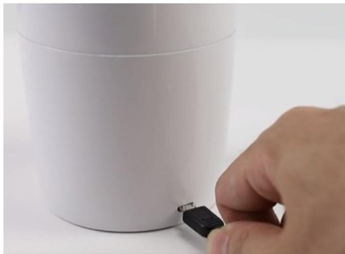
С помощью кабеля, входящего в комплект поставки, подключите устройство к любому разъему USB с силой тока не менее 1 А. Процесс полной зарядки занимает около 2 часов. Когда аккумулятор заряжается, на корпусе устройства мигает синий светодиодный индикатор. Когда процесс завершен, индикатор горит непрерывно.
