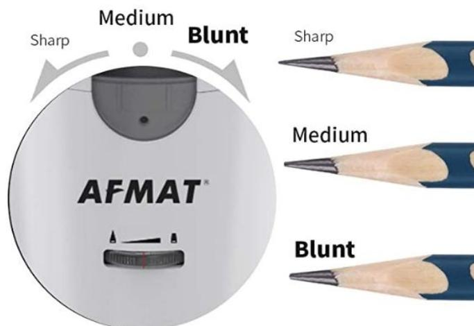
С его помощью вы можете выбрать один из трех углов заточки: Sharp (острый), Medium (средний) и Blunt (тупой). Более острый вариант предназначен для карандашей высокой твердости, оставляющих на бумаге самые тонкие линии; для мягких грифелей подходит больший угол заточки, который защищает их от поломок.
