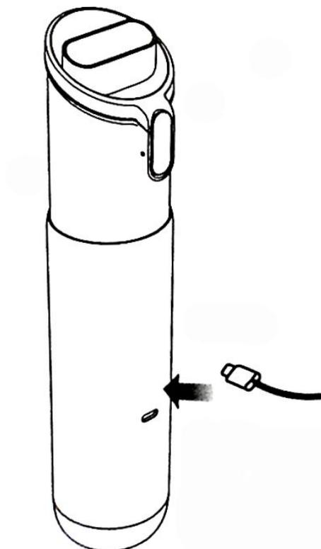
С помощью кабеля, входящего в комплект поставки, подключите устройство к адаптеру питания с силой тока не менее 2 А. Время полной зарядки составляет не менее 3 часов. Наблюдать за ходом процесса зарядки можно с помощью трех светодиодных индикаторов, расположенных над кнопкой включения. Когда все три индикатора горят непрерывно, зарядка завершена.
