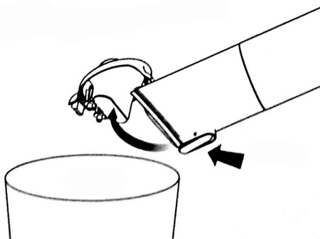
Для этого нажмите на защелку, расположенную на боковой стороне контейнера, чтобы откинуть крышку. После этого переверните устройство и высыпьте пыль в урну.
