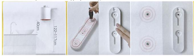
Расположите крепление (5) на нужной высоте. Вы можете закрепить кронштейн с помощью клея или двух дюбелей, входящих в комплект. При использовании клея обработайте области, указанные на схеме, плотно прижмите крепление к стене и удерживайте 20-30 секунд. После этого необходимо подождать 48 часов, чтобы дать клею полностью застыть.
