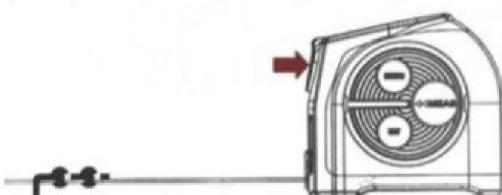
**Блокировка.** Лента рулетки блокируется автоматически. Нажмите кнопку блокировки ленты для втягивания ее в корпус рулетки. Отпустите кнопку для остановки втягивания ленты.
