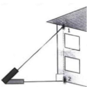
**Косвенное измерение (измерение катета).** Если для полного измерения высоты необходимо произвести два или три замера, можно воспользоваться функцией косвенного измерения.
