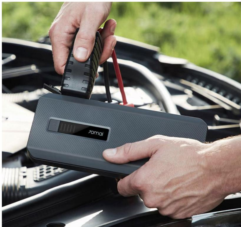
2. Подсоедините зажимы аккумулятора автомобиля, соблюдая полярность. Красный зажим должен быть подключен к положительному (+) контакту, а черный – к отрицательному (-).
