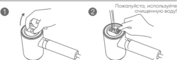
3. Откройте крышку резервуара для воды, добавьте воду в резервуар для воды, пока уровень воды не достигнет горловины, и закройте крышку резервуара для воды.
