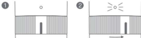
6. Включите питание и поверните поворотный переключатель в режим горизонтального гладжения (глажение одежды в горизонтальном положении), индикатор начнет мигать красным светом, и устройство начнет работать; если индикатор горит долго и паровая плита начинает распылять пар, можно выполнить вертикальное глажение ( обратите внимание: вертикальное глажение не разрешено в режиме плоского глажения).
