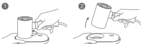
2. Поверните основной корпус против часовой стрелки и отделите плоскую гладильную пластину от основного корпуса.
