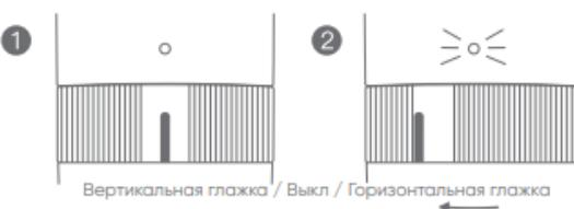
4. Включите питание и поверните поворотный переключатель в режим вертикального глажения (глажение подвешенной одежды), индикатор начнет мигать синим светом, и устройство начнет работать; когда индикатор горит долго и паровая плита начинает распылять пар, можно выполнить вертикальное глажение (обратите внимание: в режиме вертикального глажения не выполняйте горизонтальное глажение)
