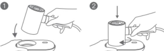
5. Установка плоской гладильной панели: направьте наконечник стрелки на основном корпусе в положение разблокировки на плоской гладильной панели. Вставьте основной корпус в панель, аккуратно нажмите вниз и поверните док-станцию основного корпуса, прикрепите панель к основному корпусу. (Примечание: перед установкой или отсоединением плоской гладильной панели устройство должно быть выключено, а его основной корпус полностью охлажден.)
