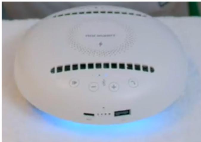
Для зарядки робота подключите его к адаптеру питания с силой тока не менее 1 А, используя комплектный кабель. Зарядка начнется и завершится автоматически, наблюдать за ее ходом вы можете с помощью четырех светодиодных индикаторов, расположенных около разъема.
