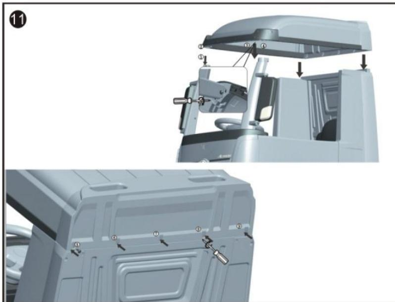
Установите крышу кабины. Зафиксируйте.
