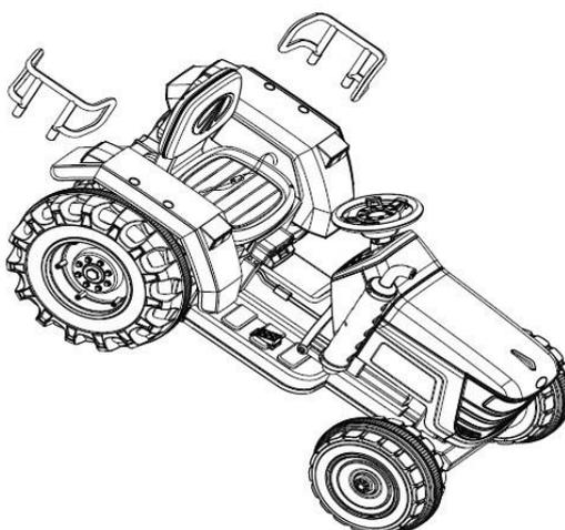
1. Установите и зафиксируйте опорные рамы кузов тр. средства.
