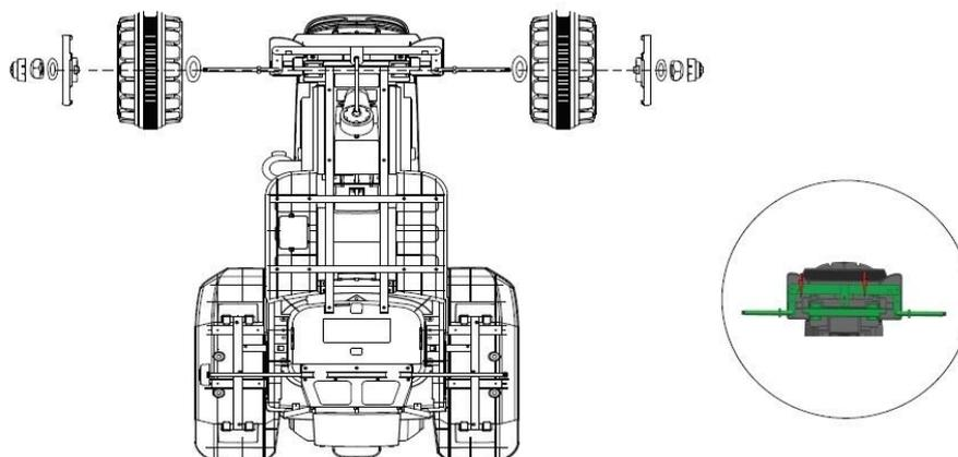
1. Зафиксируйте переднюю ось тр. средства с помощью винта и шайбы.
