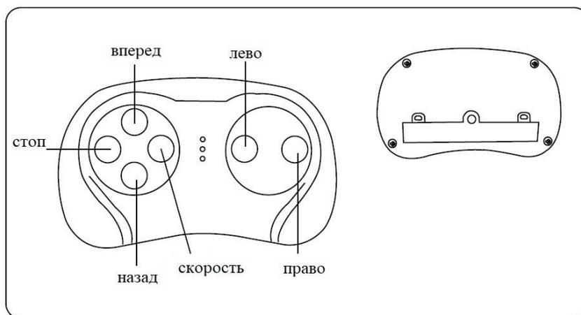
Откройте крышку на задней панели пульта Д/У, вставьте 2АА 1,5 батареи и закройте крышку батарейного отсека.
