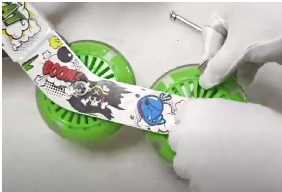
Установите одно из колес на длинную ось. Проденьте конец оси в отверстие на раме.
